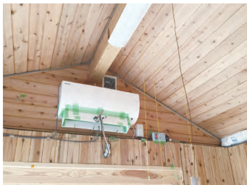
◀写真2 (左)・3 (右) 実験には写真2のようなグローブ式の温度計のほか、外気温湿度計など、計45カ所にセンサーが設置されている。またログハウスの外壁の内側にパネルログが取り付けられている様子などがわかる
