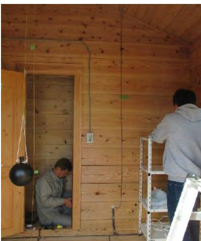
▲センサー取付作業の様子。タテログを撤去する時に一旦センサーを仮撤去し、一般ログハウスに変身後、再び取りつけて次の実験に備える。
